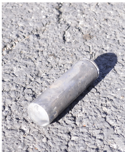
Bild 3 Heiße zylindrische LIB-Zelle, circa 30 m vom Versuchsaufbau entfernt. Foto: Fogtec
