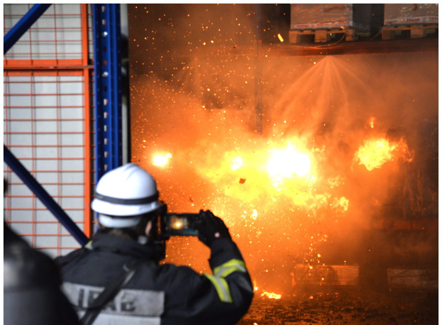
Großbrandversuche mit Lithium-Ionen-Batterien. Foto: Fogtec
