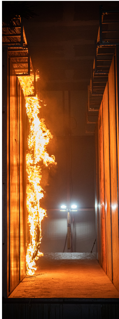
Echtbrandversuch im Rahmen einer FM-Global-Zulassung für den Whitespace. Foto: Fogtec
