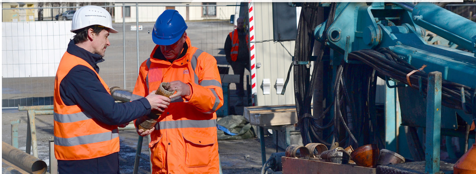
Prélèvement d'échantillons de sol pour la planification de la nouvelle ligne ferroviaire Dresde-Prague.
