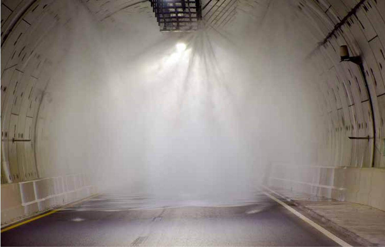
All tests and acceptance procedures within the scope of commissioning, including several pressure and spray tests, were carried out successfully. Alle Tests und Abnahmeversuche im Rahmen der Inbetriebnahme, inklusiver mehrerer Druck- und Sprühversuche, wurden erfolgreich durchgeführt.
